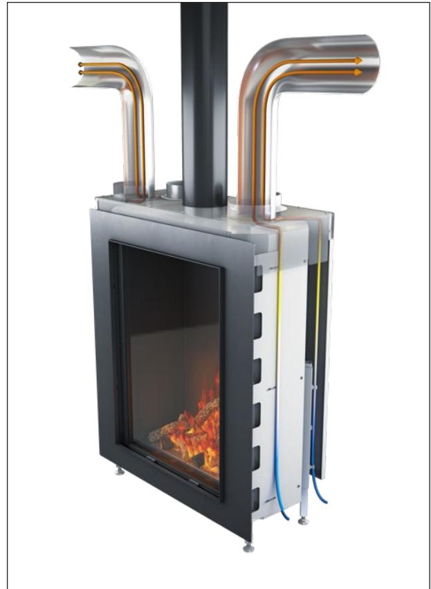
· Les foyers au gaz Stûv sont conçus pour être raccordés avec des conduits concentriques en inox. Les appareils sont étanches et prélèvent l'air nécessaire à la combustion via le canal périphérique du conduit. Cet air est réchauffé au contact du tube intérieur du conduit qui évacue les fumées.
